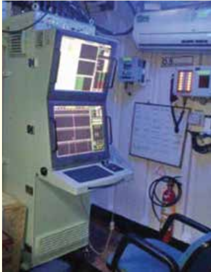
भारतीय नौसेना के प्लेटफॉर्म पर कर्षित व्यूहयुक्त मारीच सोनार प्रक्रमण प्रणाली तथा विंच।
