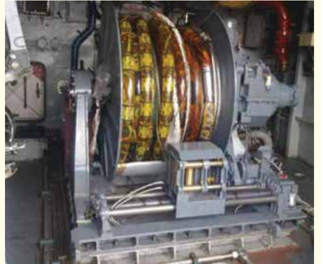
भारतीय नौसेना के प्लेटफॉर्म पर कर्षित व्यूहयुक्त मारीच सोनार प्रक्रमण प्रणाली तथा विंच।
