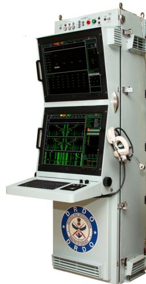
Fig. 3. Display Cum Processor Cabinet
