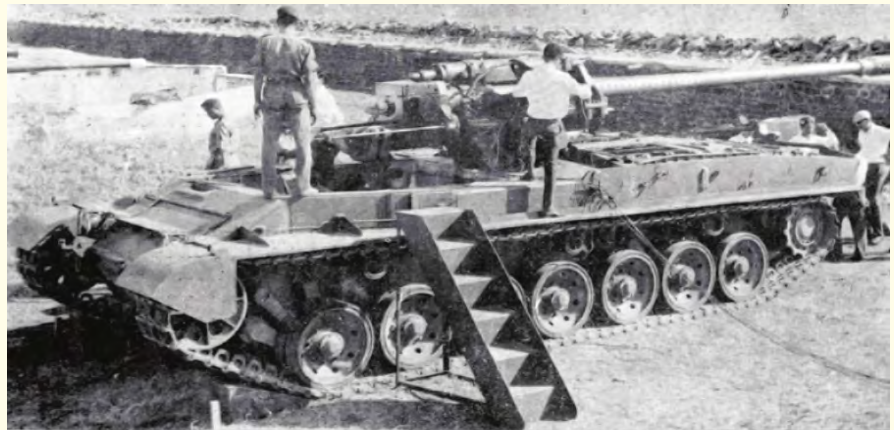
विजयंत चेसिस पर 130 मिमी का स्वतः नोदित होने वाला बंदूक (सेल्फ प्रोपेल्ड गन)
