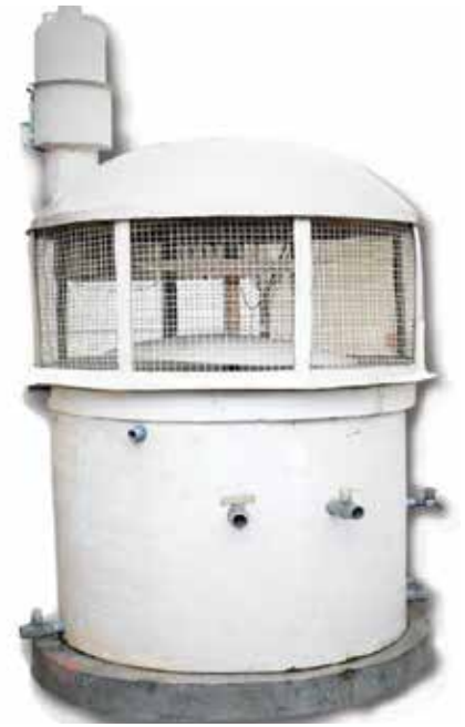
जल को लौह तत्वों एवं आर्सेनिक के संदूषण से मुक्त करने वाला डीफेराइजेशन-कम-डीआर्सेनिकेशन यूनिट
