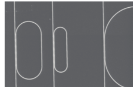
ई-बीम लिथोग्राफी के द्वारा फैब्रिकेटेड फोटोनिक वायर वेवगाइड्स का प्रयोग कर एक माइक्रो-रिंग रिजोनेटर की एसईएम इमेज।
