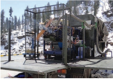
समुद्र तल से 6752 फीट की ऊंचाई पर स्थित मनाली में सचल परीक्षण प्लेटफार्म पर टर्बो चार्जर्ड ई एफ आई इंजन
