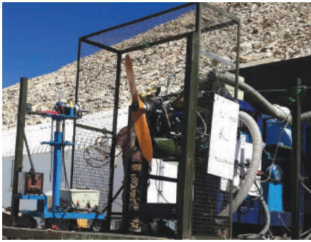
समुद्र तल से 17,500 फीट की ऊंचाई पर स्थित चांग-ला में सचल परीक्षण प्लेटफार्म पर टर्बो चार्जर्ड ई एफ आई इंजन
