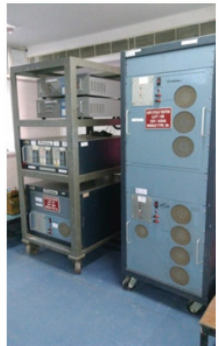
आवश्यकता के अनुरूप परिवर्तनशील स्थिर धारा/स्थिर विभव चार्जर
