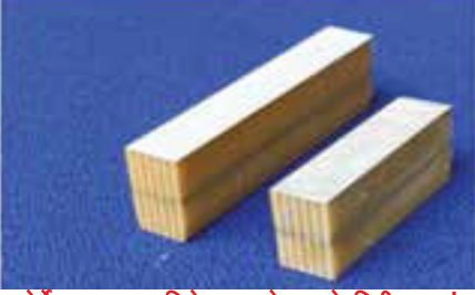
पोर्टेबल डाइवर डिटेक्शन सोनार के रिसीवर एवं प्रोजेक्टर ट्रांसड्यूसर एरेज के लिए 2-एलिमेंट पाइजोकम्पोजिट स्टैक्स
