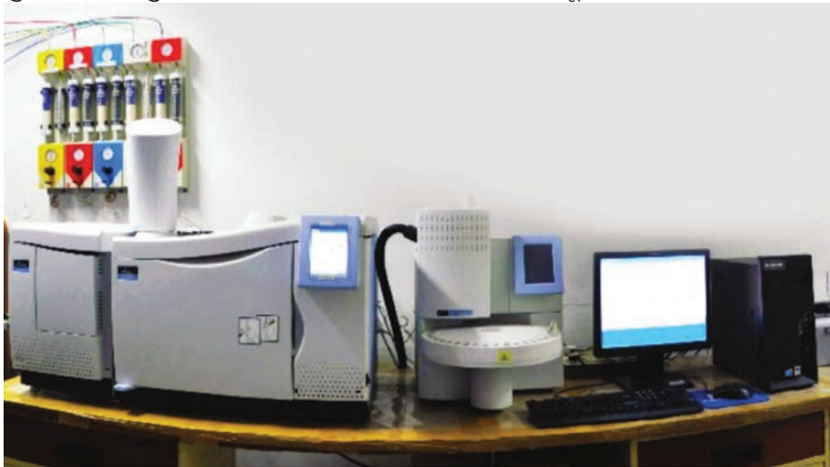
मास स्पेक्ट्रोमीटर सहित गैस क्रोमेटोग्राफ, इनसैट : इंडक्टिवली कपलड प्लाज्मा स्पेक्ट्रोमीटर
