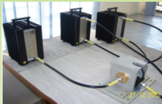
CS-114 Test Set-up
