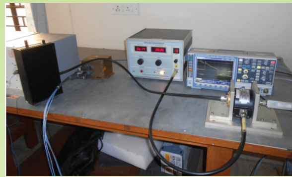
CS-115 Test Set-up
