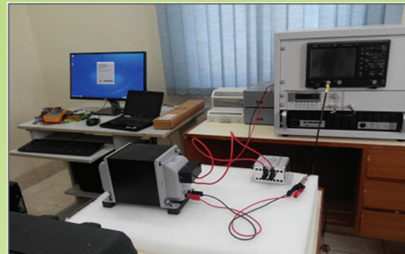
CS-101 Test Set-up
