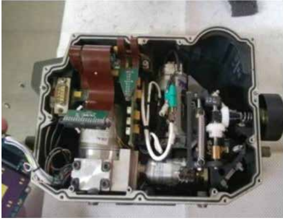
चित्र ४३. क्रायोकूलर प्रोटोटाइप के साथ संलग्न HHTI
