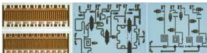
चित्र 10. (ए) 130 वाट पावर बार (बी) पावर एम्पलीफायर (सी) कम शोर वाले एम्पलीफायर
