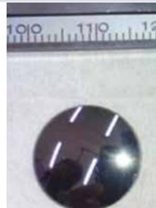
चित्र १०. जर्मेनियम ब्लैक अभिलक्षण एवं फेब्रीकेट किए गए जर्मेनियम लेंस
