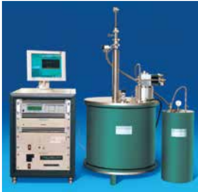
चित्र ४५. मैग्नेटो परिवहन के मापन के लिए इलेक्ट्रॉनिक प्रणाली के साथ क्रायो-स्टेट
