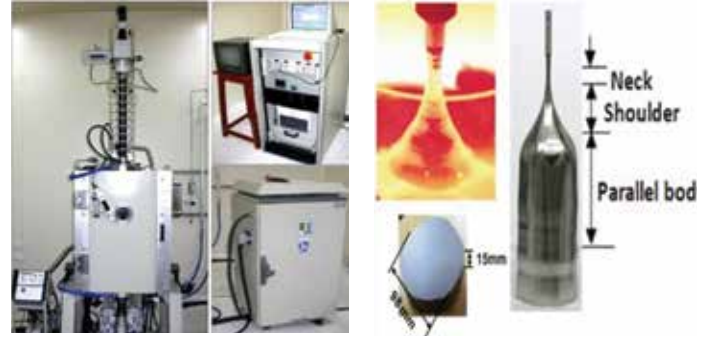
चित्र ८. सीजेड जर्मेनियम पुलर चित्र ९. ४" व्यास का जर्मेनियम क्रिस्टल एवं जर्मेनियम ब्लैक्स
